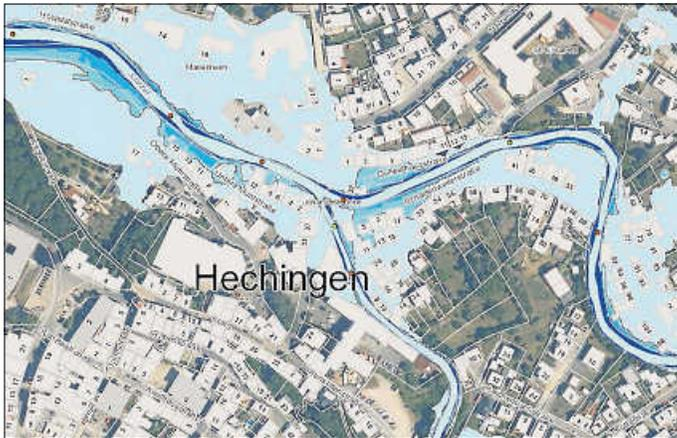
Screenshot der Hochwassergefahrenkarte mit Überflutungsflächen. Die unterschiedlichen Blautöne, von dunkel- bis hellblau, stellen die Überflutungsflächen des Wassers bei einem 10-, 50- und 100-jährlichen Hochwasser sowie bei einem Extremhochwasser (ganz hell) dar. Foto: Screenshot LUBW
